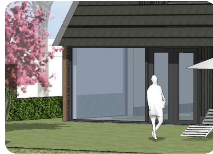
Groot raam tot op de vloer en openslaande deuren
