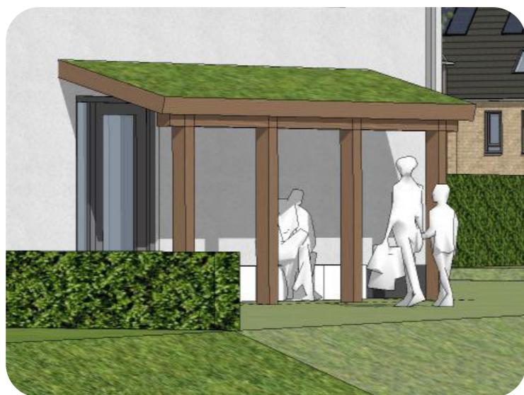
Veranda met sedumdak
