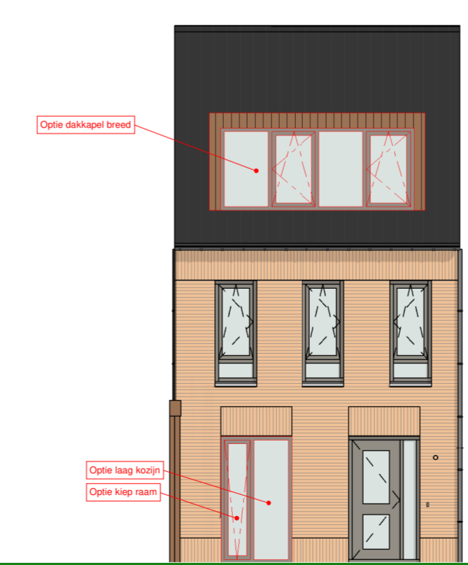
VOORGEVEL OPTIES Schaal 1:100
