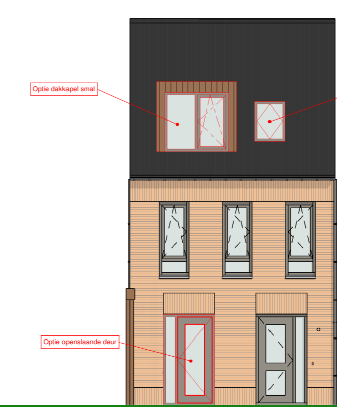
VOORGEVEL OPTIES Schaal 1:100
